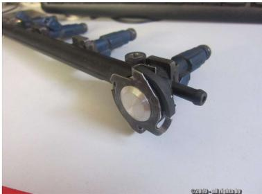
*Abbildung 47: Standardbrücke mit deaktiviertem Benzindruckregler*
