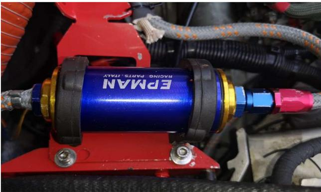
Der alte Benzinfilter wurde durch einen wiederverwendbaren Hochleistungsfilter der Marke EPMAN ersetzt. Die Montage erfolgt über die vorhandenen Verschraubungspunkte des alten Standardluftfilterkastens. Die Bauart des Benzinfilters bietet die Möglichkeit durch den Tausch des Filtereinsatzes, jeweils beim Wechsel eine zusätzliche visuelle Kontrolle durchzuführen.
