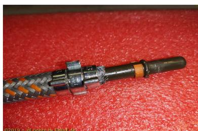
Abbildung 36: Abdichtungsversuch mit 3 Klemmschellen
