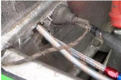
Abbildung 44: Durchbruch Benzinleitung Rückwand alt
