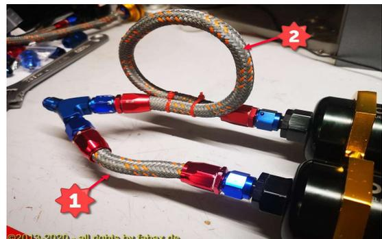
Abbildung 34: Testaufbau Looplängen Vergleich
