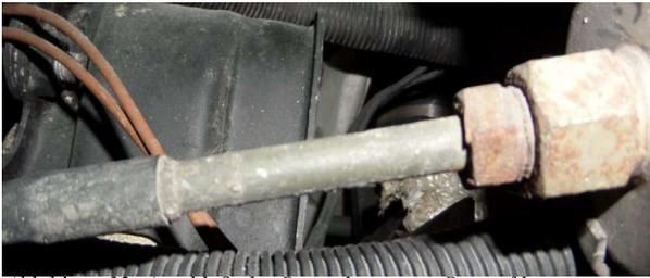
Abbildung 32: Anschluss alt - Benzinleitung an Benzinfilter
