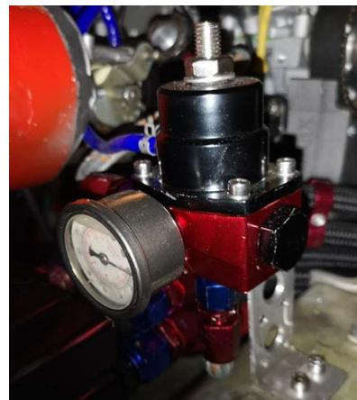
*Abbildung 49: Benzindruckregler Version 2*
