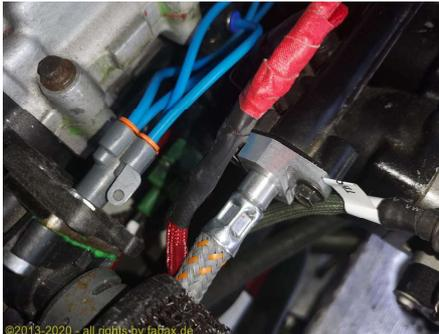
Der neue Adapter wurde vom Design an das Benzinleitungssystem AN6 angepasst und im Anschluß von einer Hydraulikfirma professionell verpresst und druckgeprüft.
