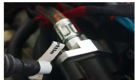
Abbildung 35: Aluanschluss an Einspritzbrücke 2
